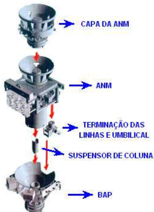
Figura 1.2 – Equipamentos do conjunto ANM
