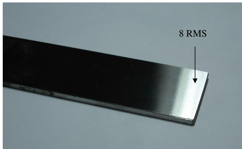
Figura 2-4 – Chapa de aço AISI 8630 mod. III 75K de 3mm de espessura com acabamento 8 RMS utilizada na visualização no AFM.
