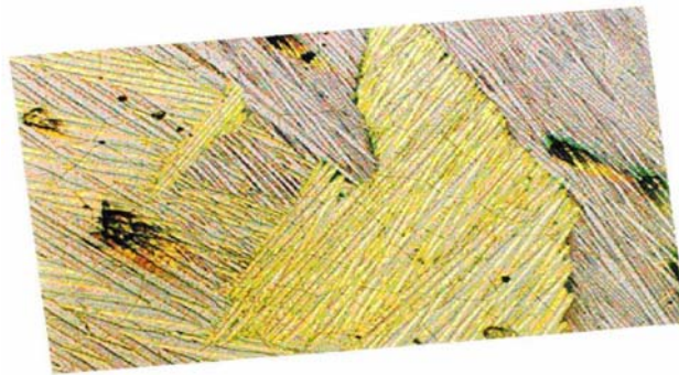
Figura 17 – Microestrutura da liga MSMA NiMnGa
