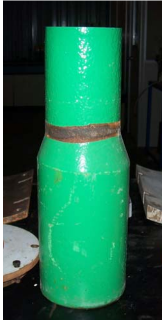
Figura 4.8 - Conexão sem Hardfacing
