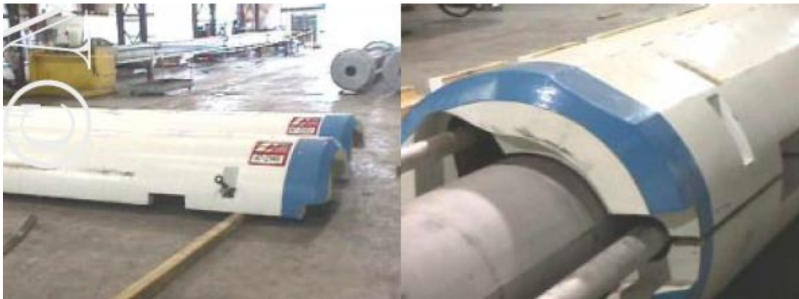
Figura 2.5 - Imagem dos flutuadores presentes nos riser em águas profundas e ultra profundas.
