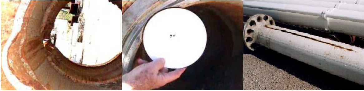
Figura 2.6 - Desgaste provocado na parede interna do riser de perfuração com contorno coincidente com o diâmetro externo da conexão da coluna de perfuração.
