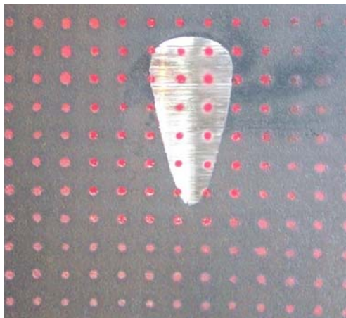
Figura 5.2 - Amostra desgastada por conexão sem Hardfacing e com Fluido Catiônico ao final de oito horas de ensaio – Ensaio 11
