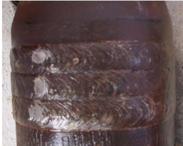
Figura 4.12 - Detalhe do Hardfacing novo
