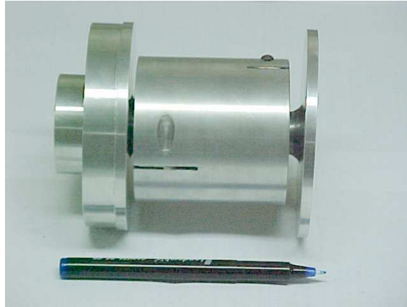
Figura VIII.10 - Célula de carga projetada e construída para a presente tese.
