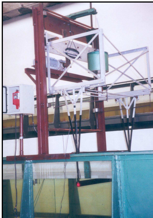
Figura III.4 - Foto do aparato com o sistema de balanceamento e com o quadro que enrijece o sistema.
