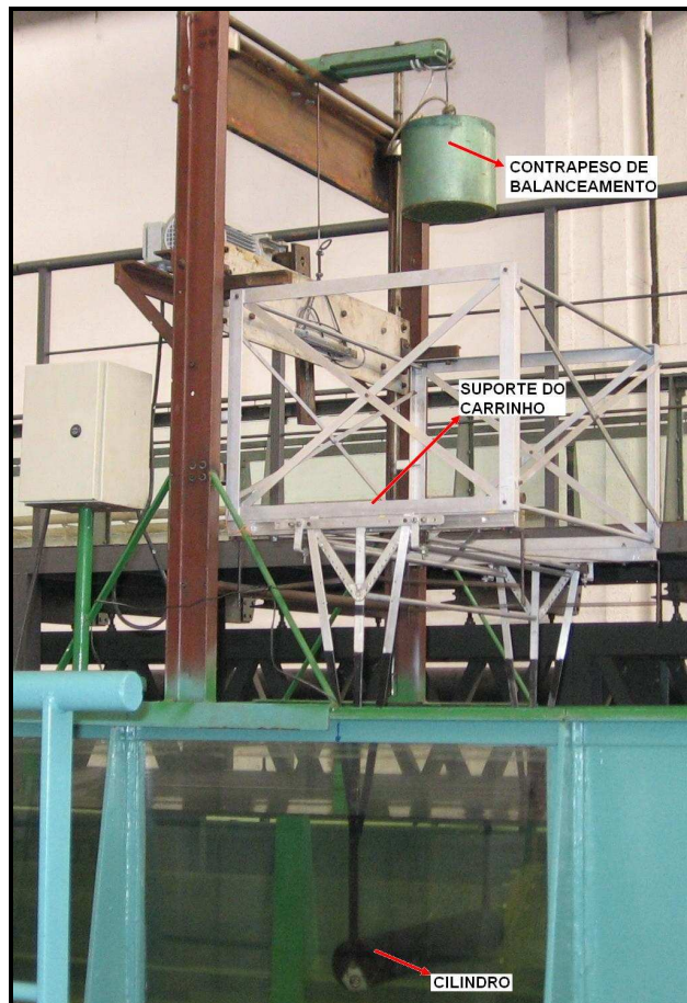
Figura III.2 - Foto do aparato; o cilindro sob estudo é horizontal; as paredes de vidro do canal de ondas do LOC permitem a visualização; a mesa suporte do aparato é oscilada verticalmente.
