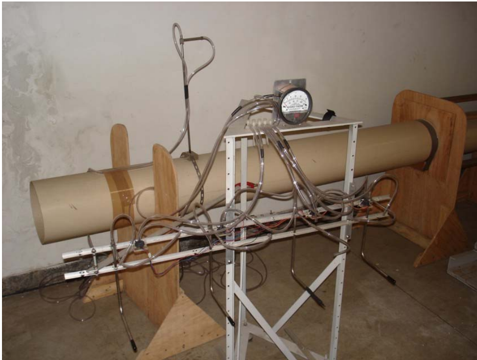
Figura 5.3- Manômetro, Tubos de Pitot e Sensores Eletrônicos durante o processo de calibração.
