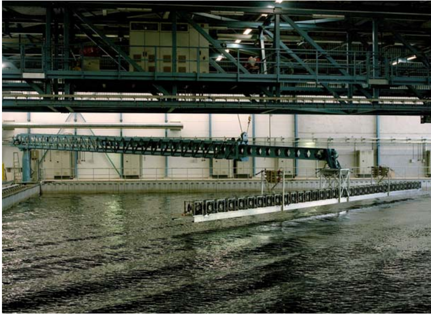
Figura 4.9 – Banco de Ventiladores, MARIN- Holanda (Buchner, Cozijn et al. , 2001)
