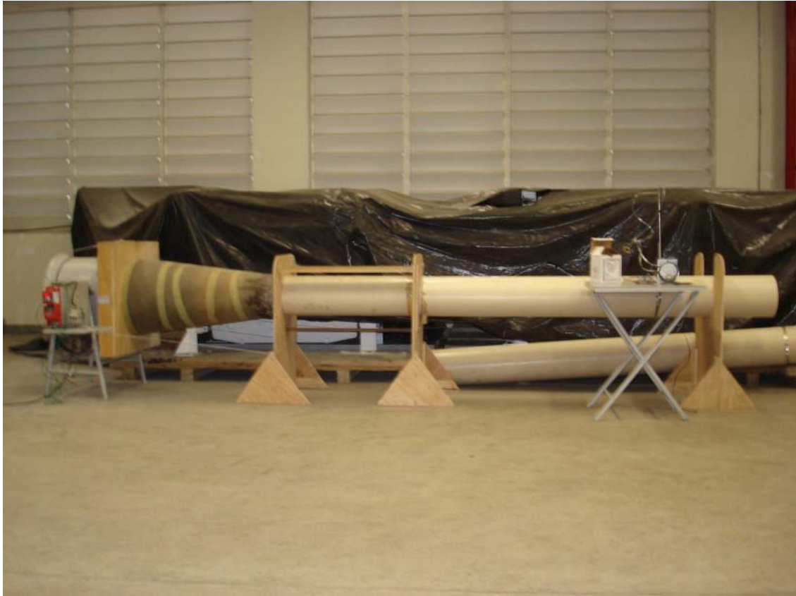
Figura 4.12 – Protótipo do Túnel de Vento construído.
