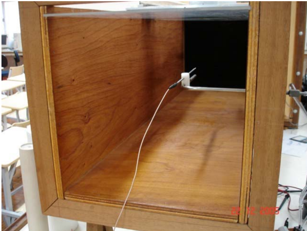
Figura 5.7 – Sensor de fio-quente e Tubo de Pitot durante a calibração.
