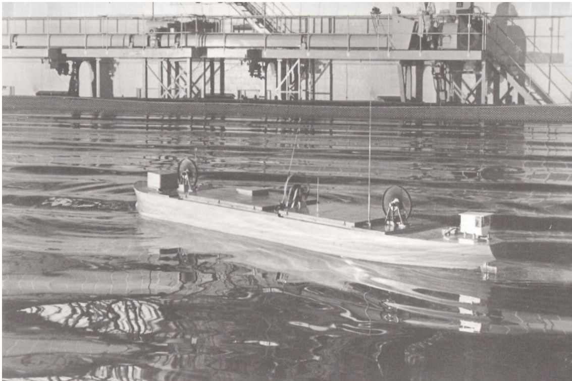
Figura 4.5 – Simulação de forças utilizando 3 ventiladores a bordo (OCIMF, 1981)
