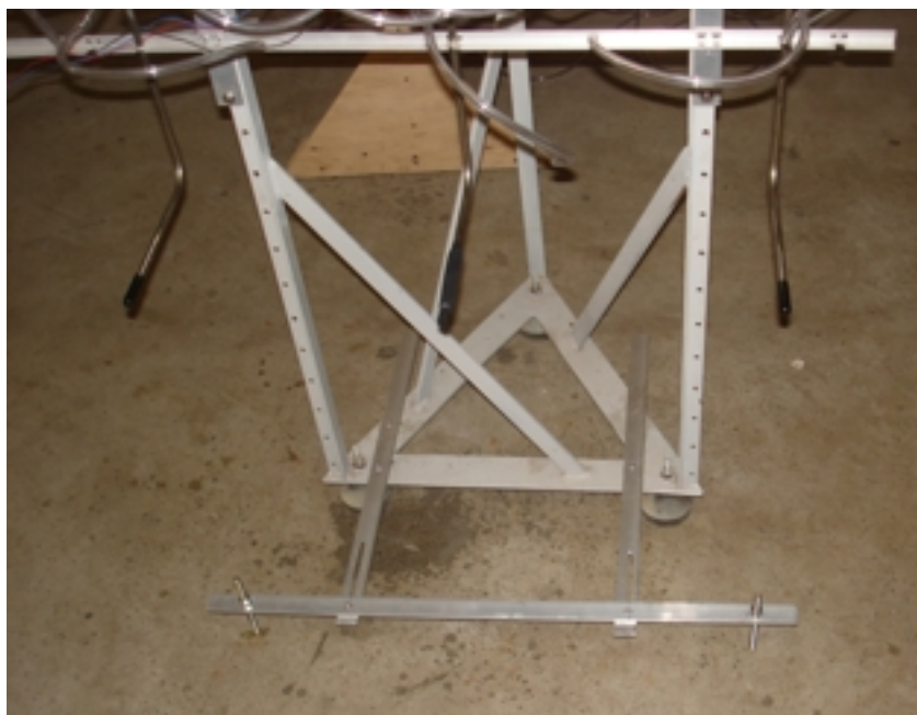
Figura 5.15 – Suporte para os sensores eletrônicos de pressão.
