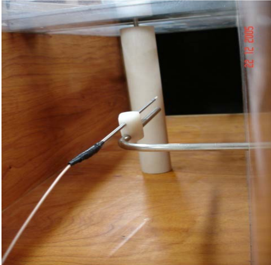
Figura 5.8 – Sensor de fio-quente e Tubo de Pitot após cilindro gerador de turbulência.
