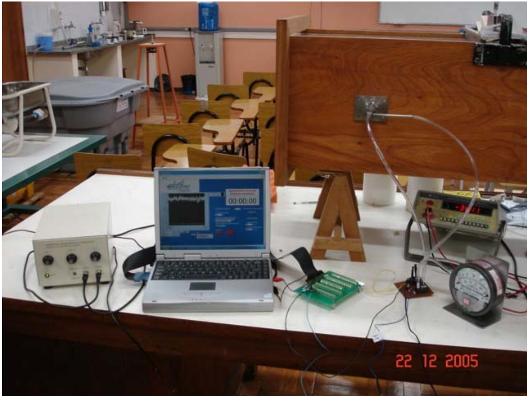
Figura 5.6 – Visão geral do ensaio comparativo entre os sensores de fio-quente e de pressão eletrônico.
