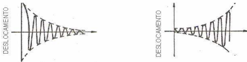
FIG 6.12 MOVIMENTO VIBRATÓRIO ESTÁVEL E INSTÁVEL
