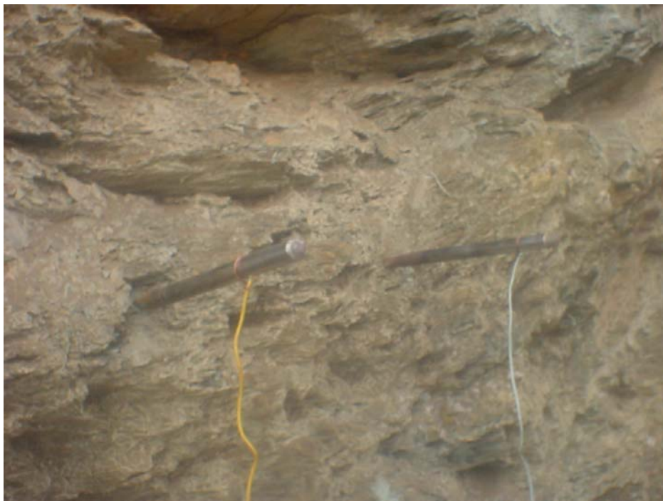
Foto 7. Detalhe da medição de resistividade no afloramento de clorita xisto.
