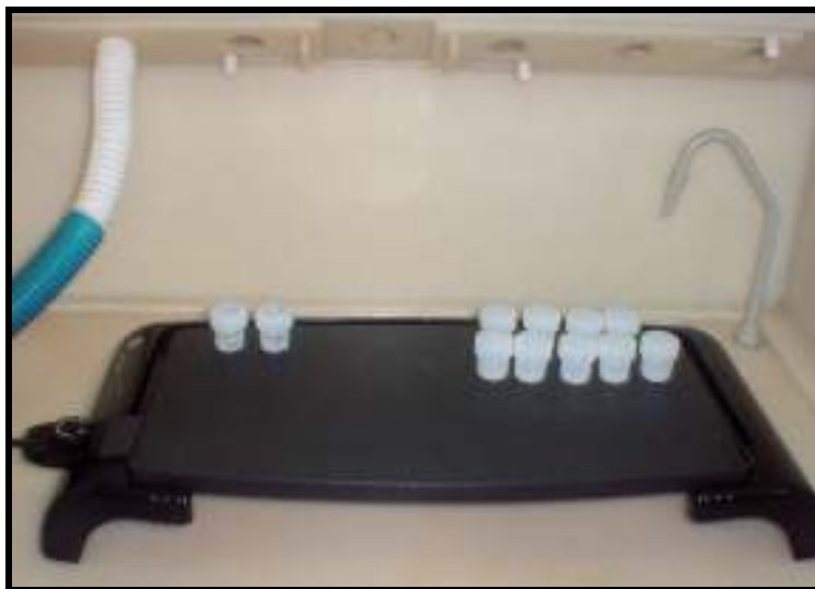
Figura 3.3 Detalhe mostrando a chapa quente com os savilex contendo as soluções (modif. Silva, 2006).
