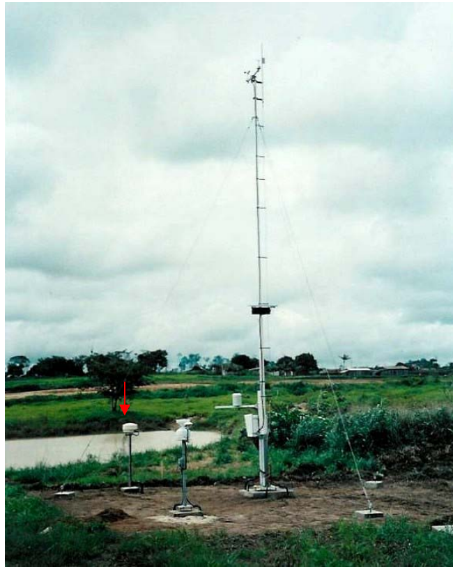
Figura 3.12 – PCD meteorológica do INMET com AUTOTRAC Fonte: (HOBECO, 2005)
