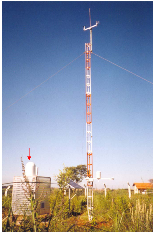
Figura 3.10 - PCD meteorológica da CEMIG com INMARSAT C Fonte: (Foto realizada pelo autor, 1999)
