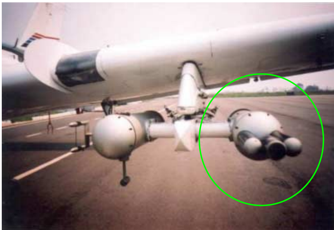
Figura 3.3 Foto da asa do avião com equipamentos de medição instalados. Em destaque a imagem da sonda FSSP-100.
