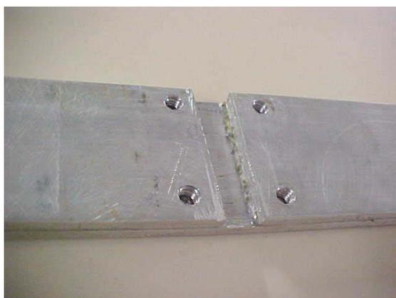
**Foto 4-3 – Linha de furos 2 e 3 (vide figura 4-8) rosqueadas para travamento da camada de restrição.**
