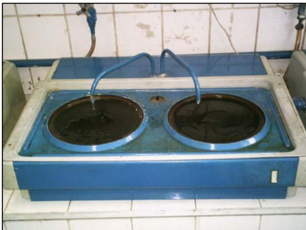
Figura 12: Discos de metalografia com as lixas d'água
