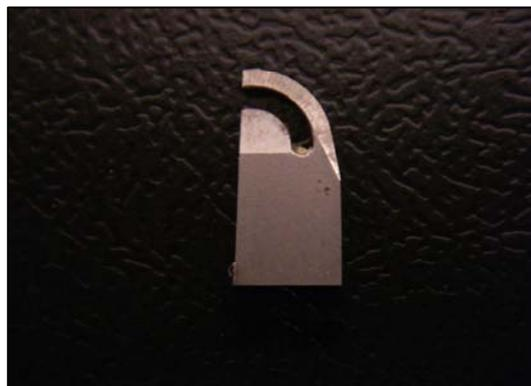
Figura 10: Secção transversal da lâmina do raspador número 5
