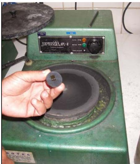
Figura 13: Lixas diamantadas para um polimento mais refinado
