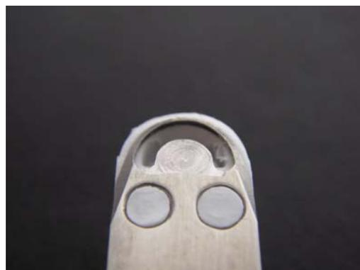
Figura 21 – Raspador 9 com lâmina plana
