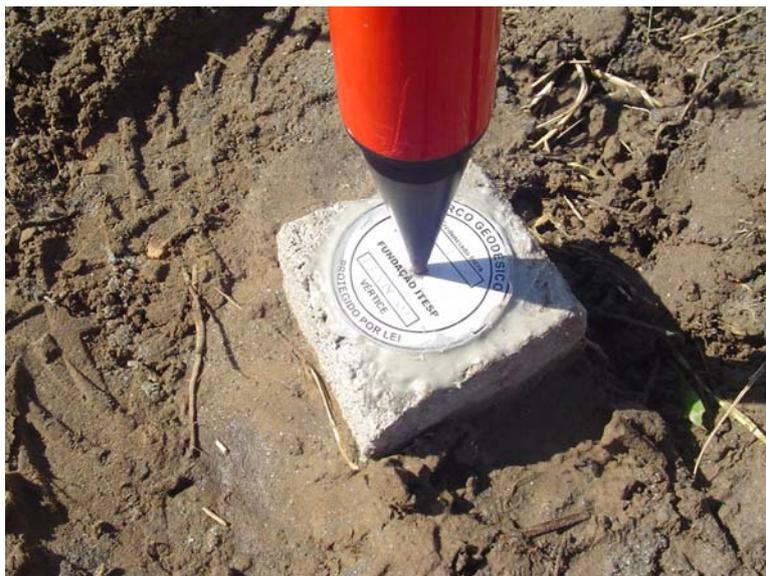
Figura 7.21 – Detalhe do marco implantado como ponto de Apoio Básico na sede do Núcleo Curucutú, município de Itanhaém.
