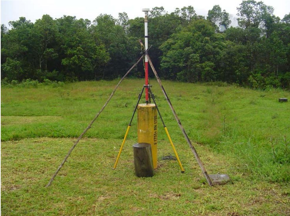
Figura 7.22 – Receptor fixo na Base (pilar da figura 7.18).
