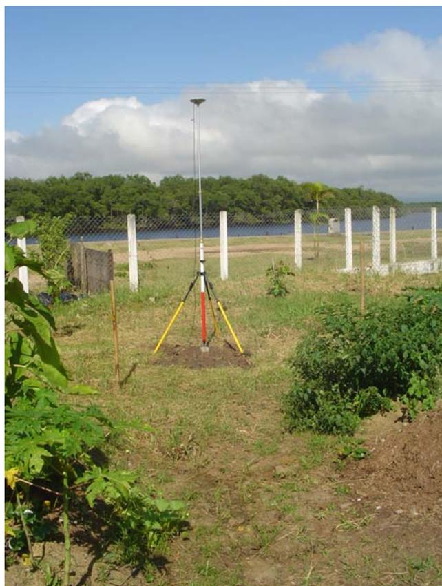
Figura 7.20 – Levantamento do Ponto de Apoio Básico na sede do Núcleo Curucutú, município de Itanhaém, realizada pelo autor do presente trabalho em novembro de 2006.
