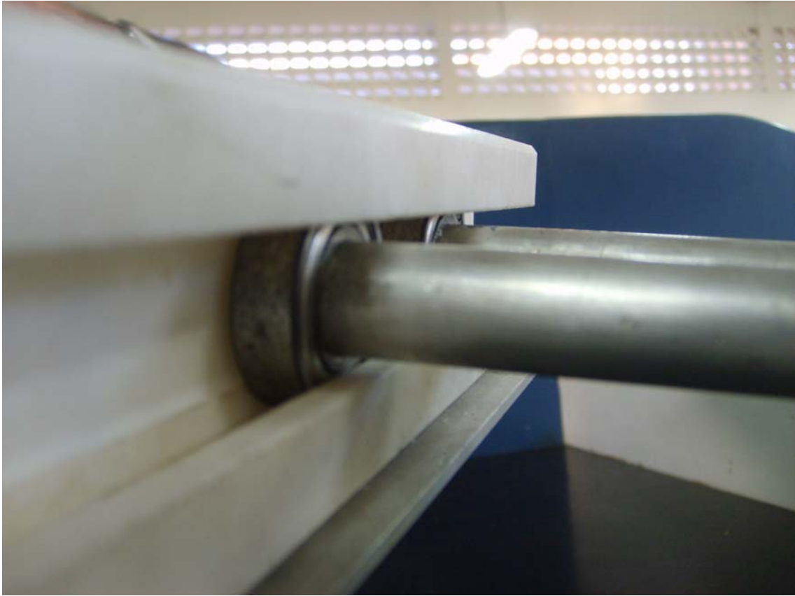
Figura 47. Detalhe da estrutura usada de guia para a translação da plataforma.
