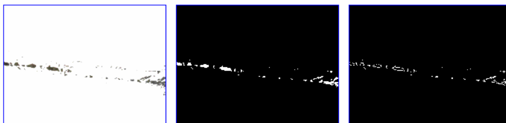
Figura 53. Processamento de imagem para um tanque limpo. a) segmentação do cordão de solda b) imagem binária c) imagem da detecção do contorno.
