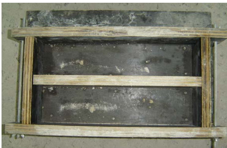
Figura 5.19 Fôrma de madeira utilizada na confecção dos corpos-de-prova
