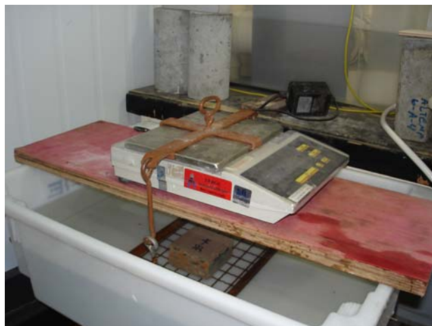
Figura 7.2 Determinação da massa aparente dos corpos-de-prova submersos em água
