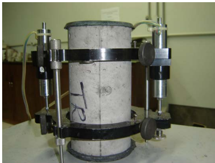
Figura 5.18 Aparato utilizado para se obter as deformações dos corpos-de-prova dos traços de concreto (LVDT)
