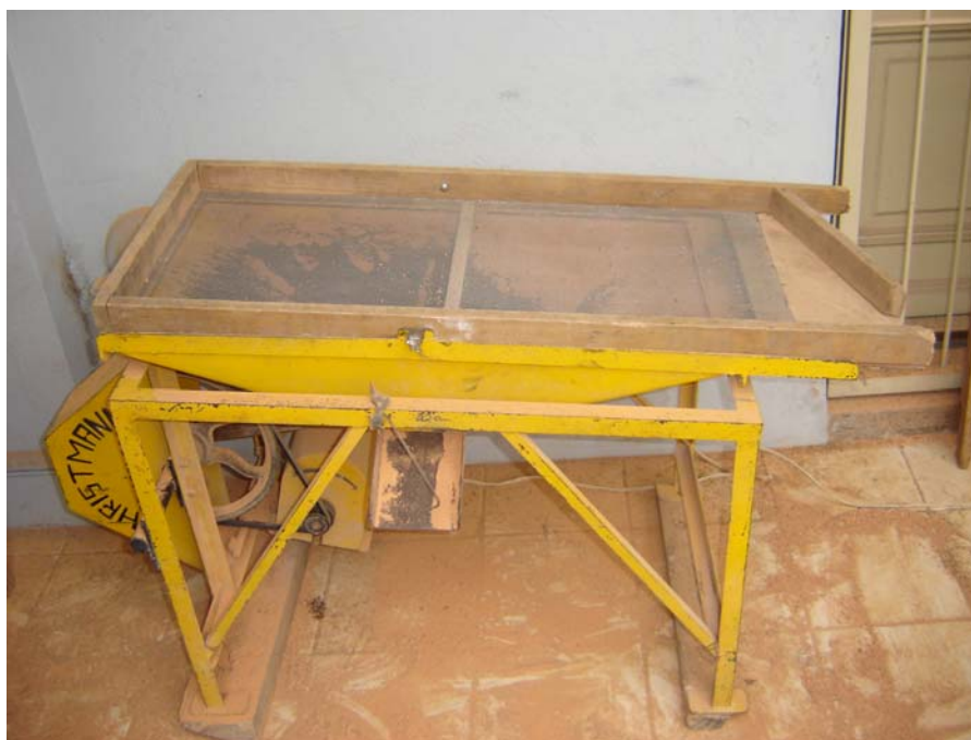
Figura 5.3 Peneirador utilizado para separar o agregado miúdo do gráudo
