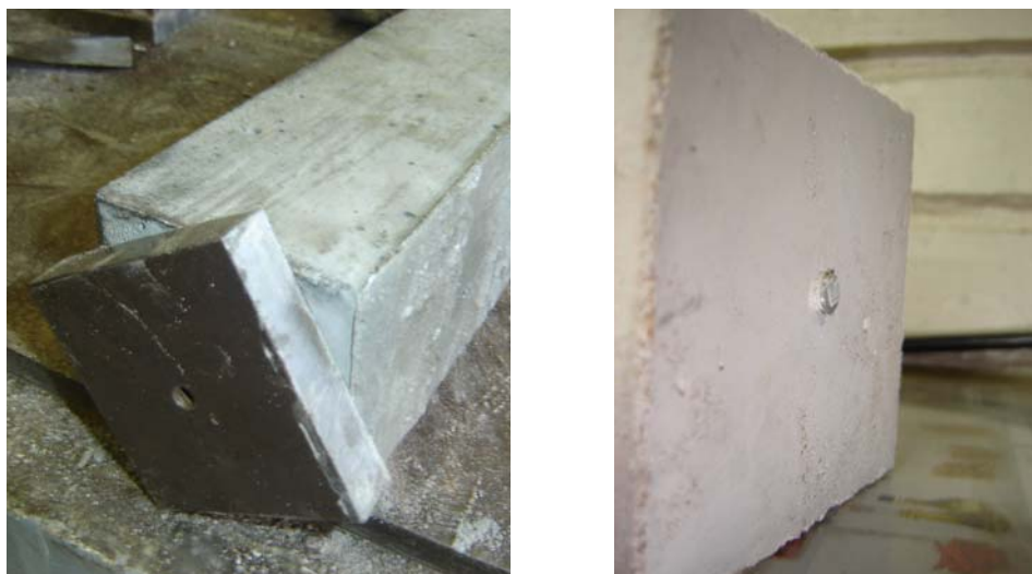
Figura 5.21 Desrosqueamento das bases metálicas
