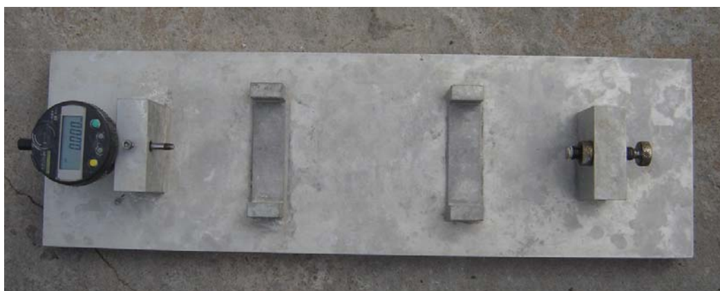
Figura 5.22 Aparato utilizado para realização das leituras de retração dos corpos-de-prova
