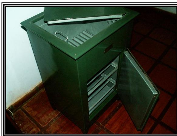
Figura 44 – Caixa térmica utilizada com gelo na parte superior para resfriar alimentos e bebidas. Autor: a pesquisadora.
