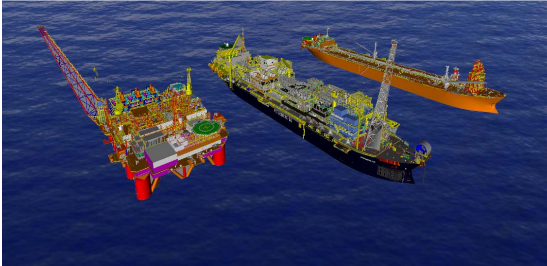
Figura 3.17 – Visualização envolvendo várias plataformas que podem ser movimentadas individualmente. Porém, seus objetos internos, não podem ser modificados, uma vez que cada plataforma possui uma hierarquia pré-definida de níveis de detalhe, ficando inviável sua modificação a cada instante.
