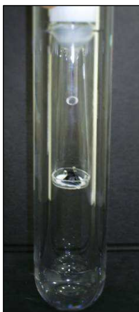
Figura 10. Amostra de petróleo na base do suporte de quartzo, no interior do frasco, para a decomposição por MIC.
