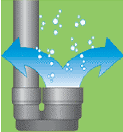
Figura 19. Etapas de funcionamento do sifão. Fonte: SICKERMANN, 2005, p. 8
