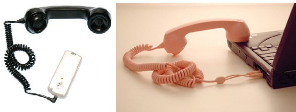
FIGURA 18: DISPOSITIVO TELEFÔNICO COM SAÍDA E ENTRADA DE ÁUDIO, PARA COMPUTADOR OU TELEFONE CELULAR 83 .
