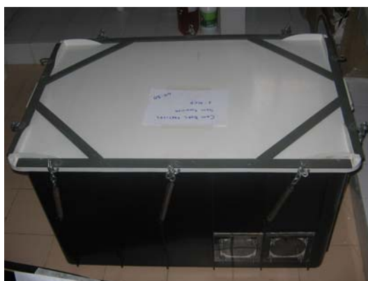
Figura 21. Caixa plástica hermeticamente fechada utilizada para aplicação do 1-MCP em melões Charentais, Areia-PB, 2005.
