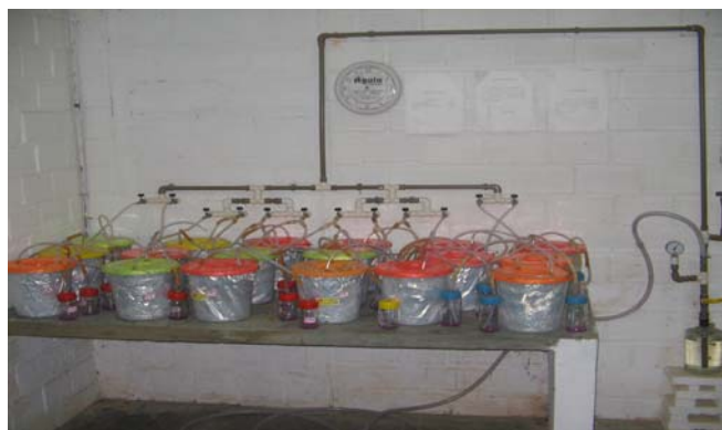
Figura 3. Conjunto para medir respiração dos melões Charentais e Pele de Sapo montado no Laboratório de Biologia e Tecnologia Pós-Colheita do Centro de Ciências Agrárias (CCA) da Universidade Federal da Paraíba (UFPB), Areia, PB.
