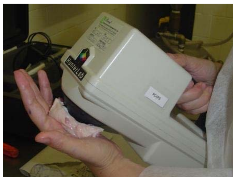
Figura 19 – Medição da cor da amostra de carne com colorímetro portátil
