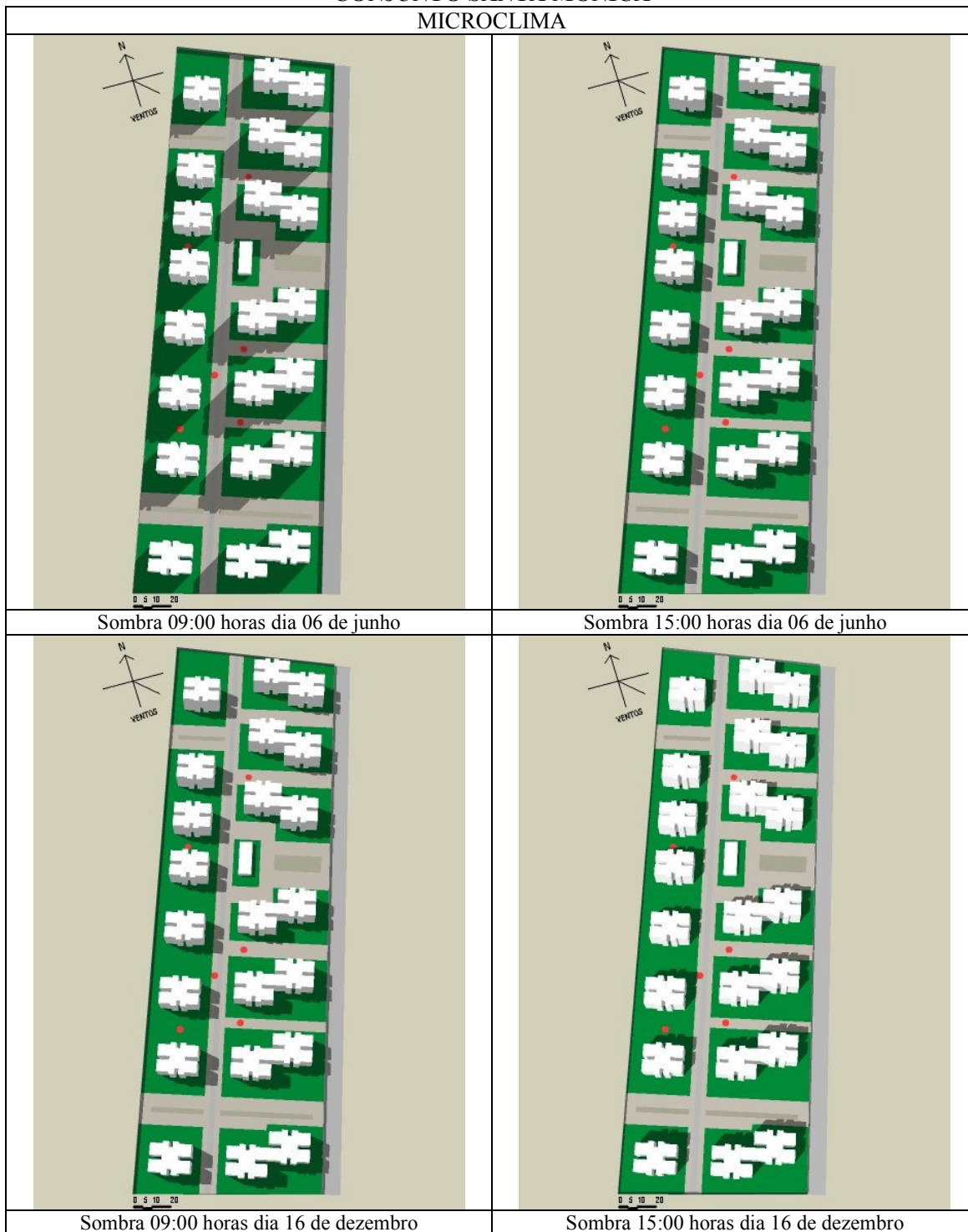
Quadro 36 – Estudo das sombras no conjunto (Fonte: http://sketchup.google.com , acessado em 15 de março de 2007).
