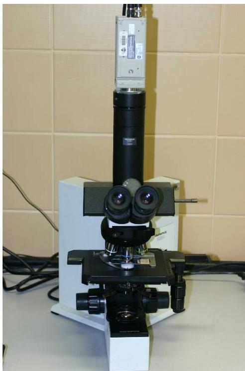
**Figura 11.** Microscópio binocular, modelo Olympus BX50 adaptado a uma câmera Sony CCD Íris Color Video, modelo DXC-107A.
