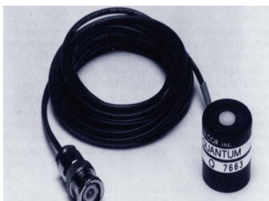
Figura 20 Modelo Sensor (PAR) instalado na Torre
