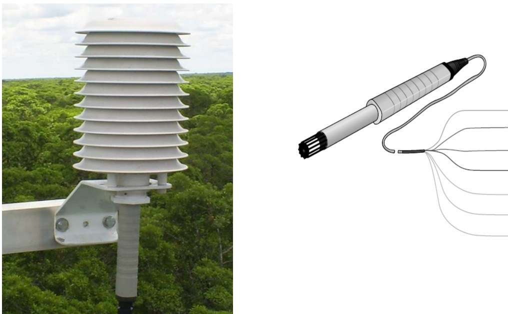
Figura 5 Psicrômetro instalado na estrutura da torre
