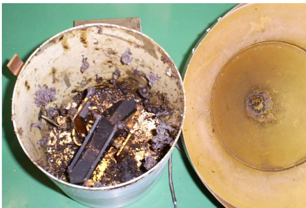
Figura 22 Pluviômetro após sofrer ação ambiental
