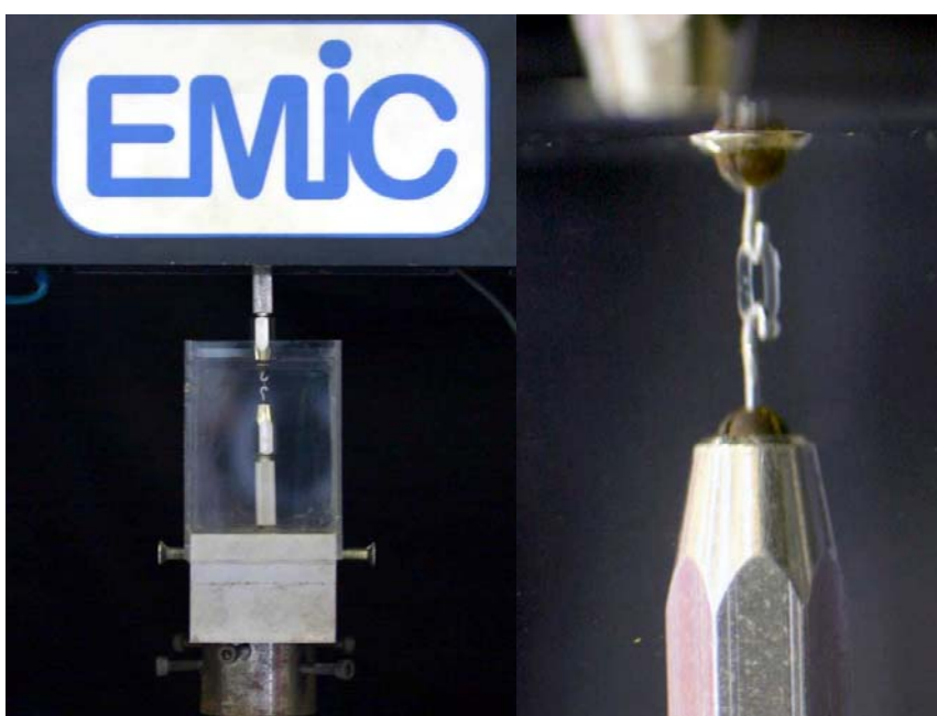
Figura 5. Dispositivo para o teste de tração posicionado na EMIC.
