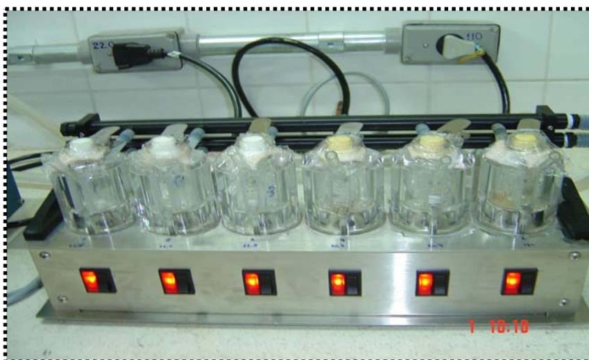
Figura 8 Sistema de difusão contendo 6 células (PERMEGEAR®)
