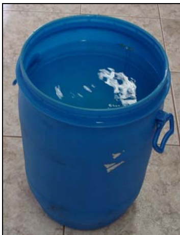
Figura 4.3 Foto da bombona de 50L utilizada para coleta de água do poço e como reator de oxidação na etapa de ensaios de adsorção em CAP seguido de tratamento físico-químico
