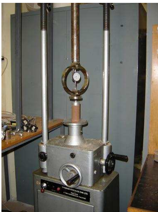
Figura 3.1a: ensaio de compressão simples
