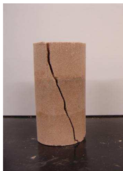
Figura 4.15b: plano de ruptura típico
