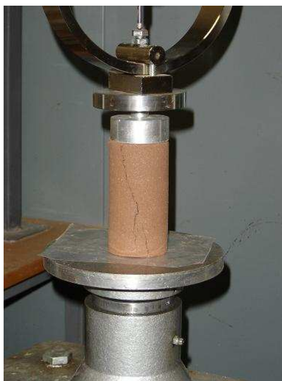
Figura 3.1b: corpo-de-prova de solo-cal-resíduo
