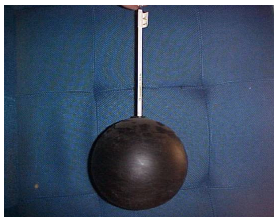
Figura 2. Termômetro de Globo Negro.
