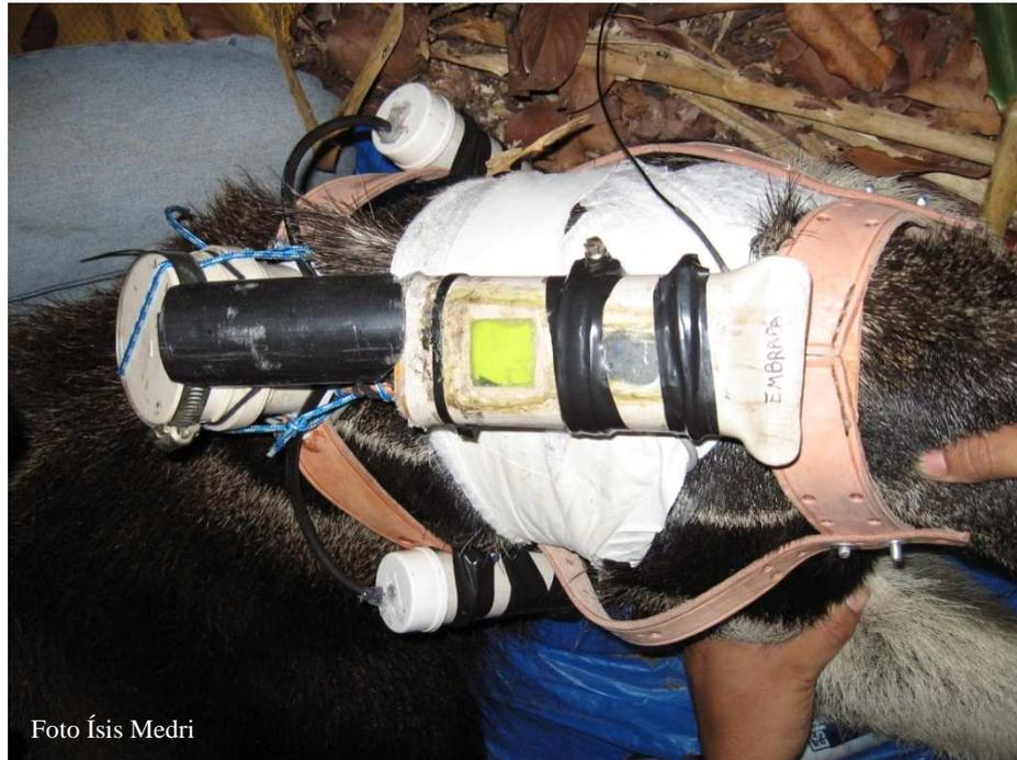
**Figura 1** – Colete com GPS modificado e data logger com sensor externo.
