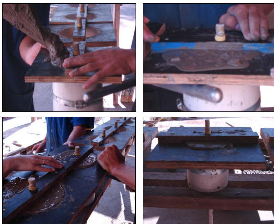
Figura 4.9 – Moldagem e adensamento dos modelos de arrancamento.
