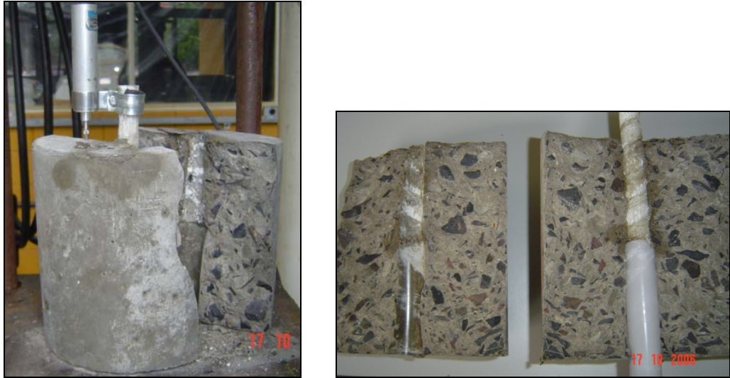
Figura 4.16 – Ruptura combinada durante ensaio de arrancamento
