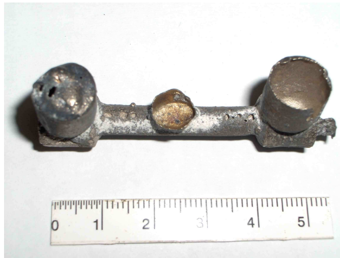
Figura 4.5 – Corpos de prova com preenchimento insuficiente
