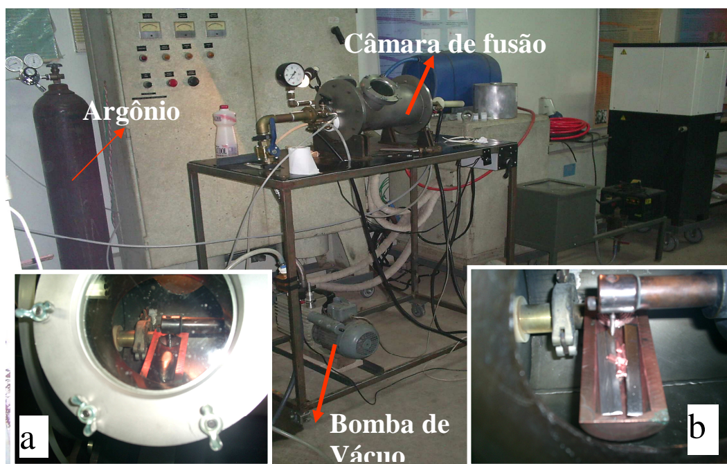
Figura 3.1 - Forno a arco: a) Câmara de fusão; b) Cadinho de cobre no interior do forno.
