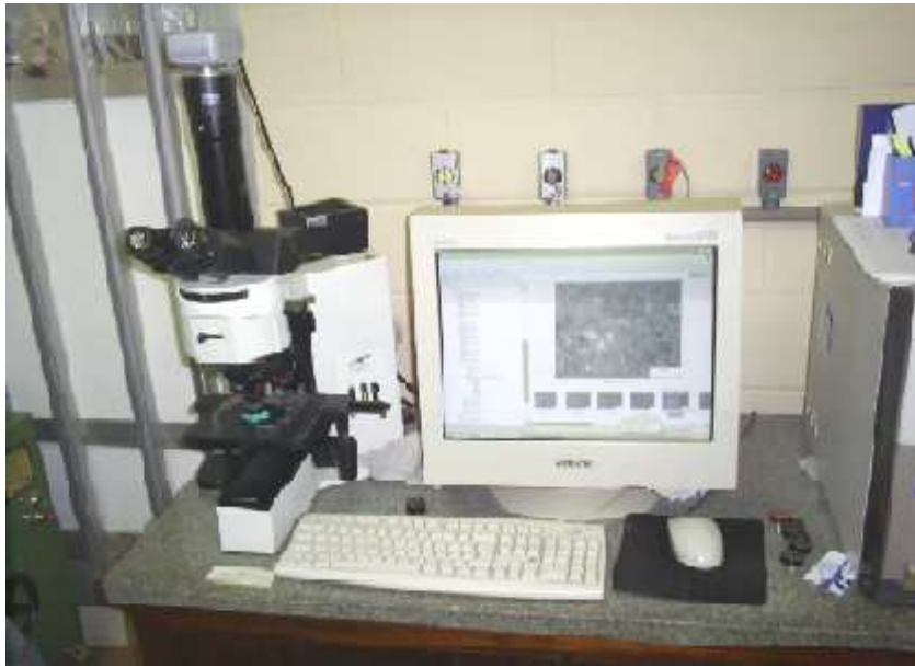
Figura 3.12: Microscópio óptico com câmera e programa para a aquisição de imagens.
