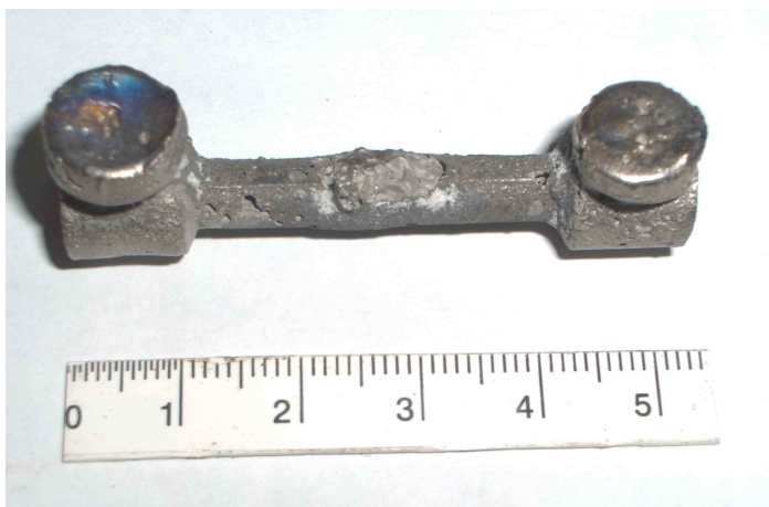
Figura 4.4 – Corpos de prova com preenchimento insuficiente
