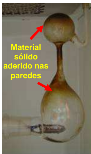
Figura 32. Câmara de combustão com material da amostra aderido nas paredes internas.
