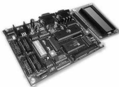
Figura 5.7: Plataforma de Desenvolvimento 8051NX da Microgênios [37].
