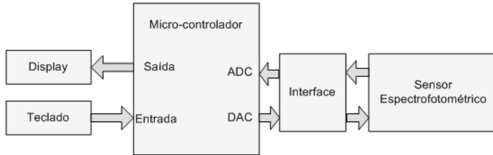
Figura 6.2: Diagrama de Bloco do Oxímetro de Pulso.
