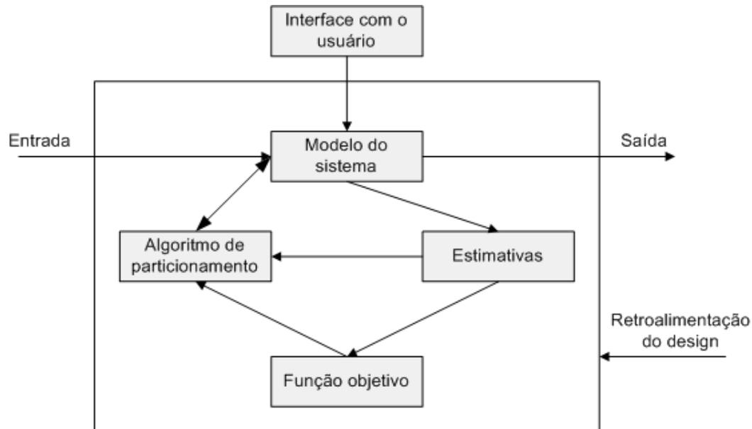
Figura 2.3: Configuração típica de particionamento de sistema.
