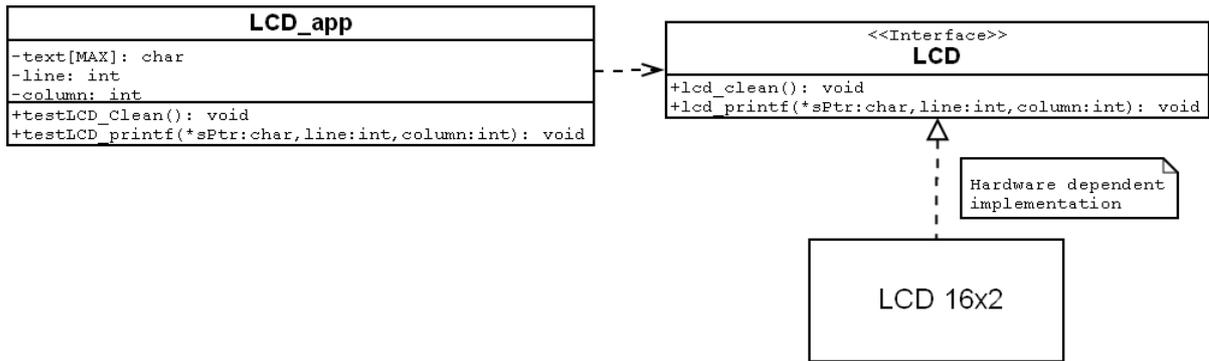
Figura 6.9: Componente que controla o hardware do display.
