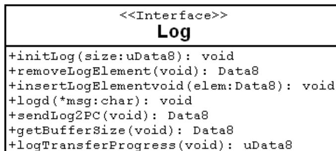
Figura C.1: Diagrama do Módulo Sistema de Log.
