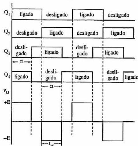
Figura 6.12: Tensão de saída do inversor monofásico [2].
