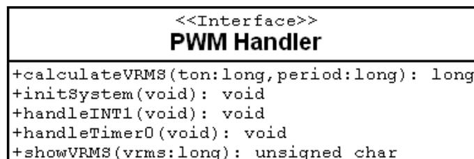
Figura C.15: Diagrama do Módulo Tratador PWM.
