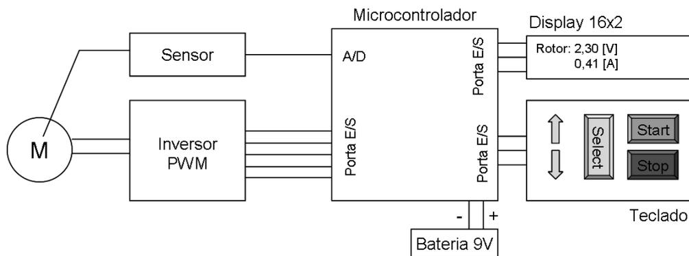
Figura 6.13: Visão Geral do *Soft-Starter* Digital.
