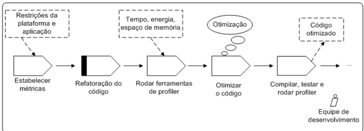
Figura 4.19: Processo para Otimização do Sistema.
