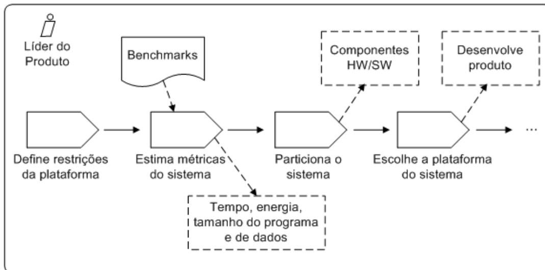
Figura 4.10: Processo para Instanciar a Plataforma.
