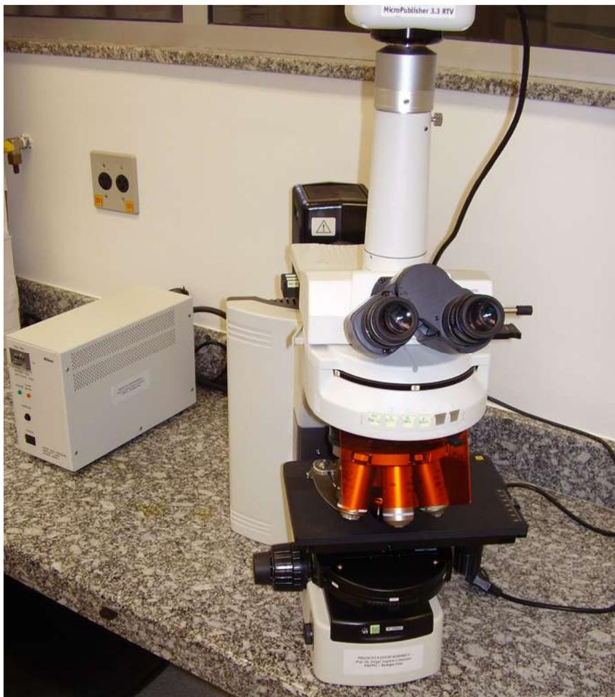
**Figura 14:** Microscópio óptico Nikon H550L – Micro Publisher 3.3 RTU. Utilizado na captação das imagens das lâminas e na histometria.
