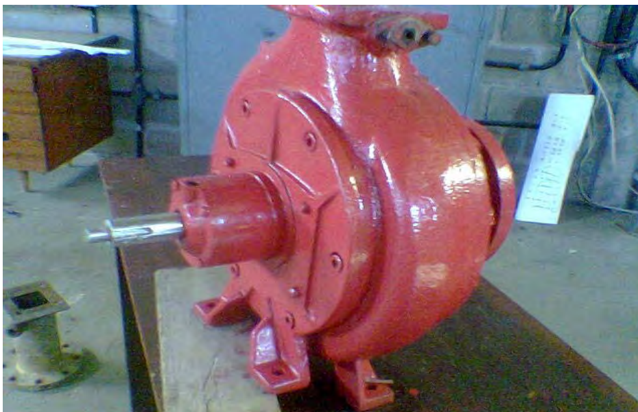
Figura 26 – Bomba centrífuga para BFT.
