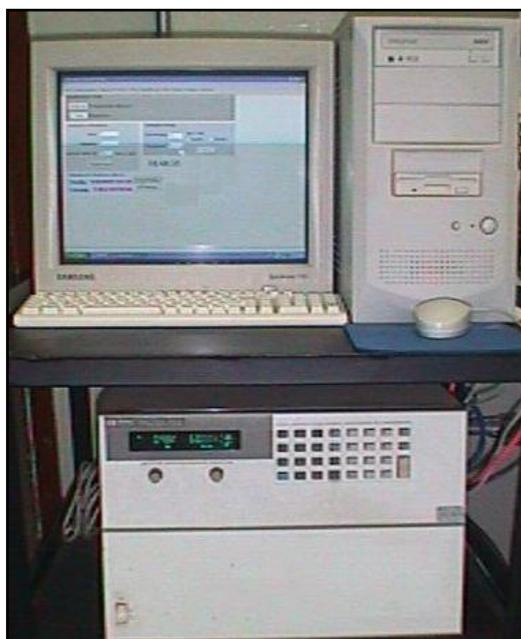
*Figura 5.2 – Fonte de tensão utilizada nos ensaios.*
