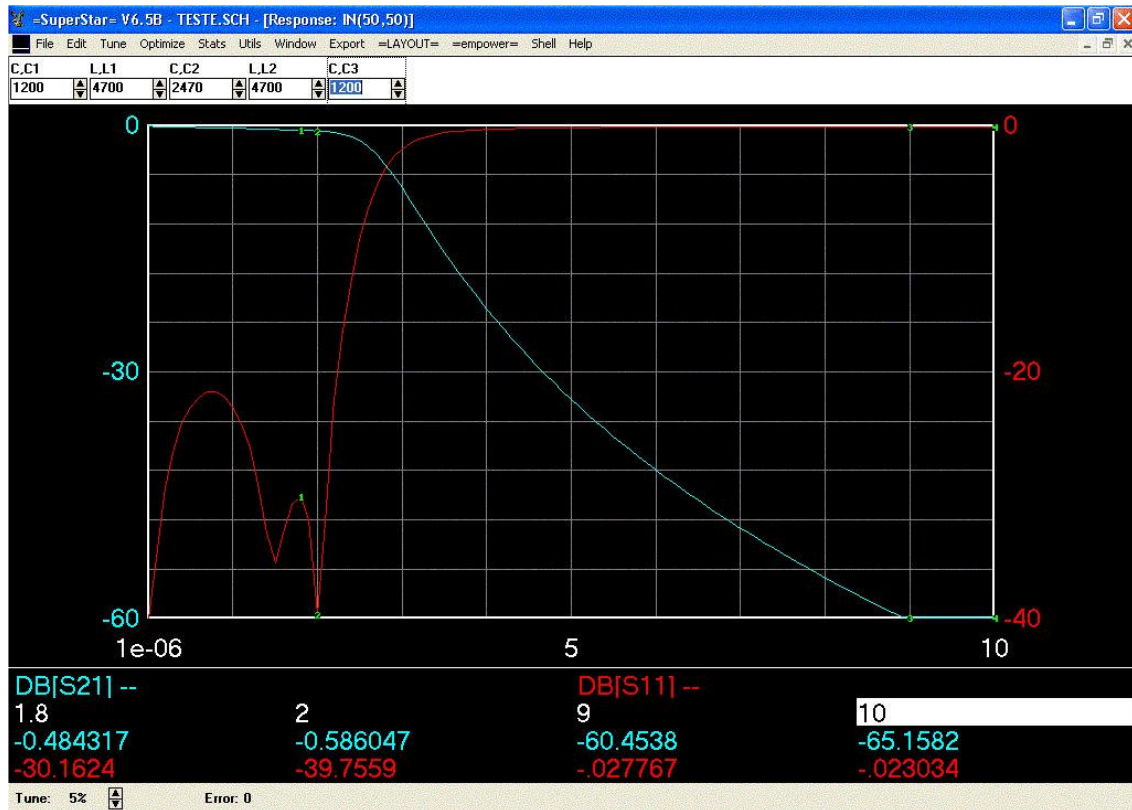
Figura 5.17 – Resultado da simulação do filtro passa-baixas de 5ª ordem apresentado pelo programa computacional Eagleware®.
