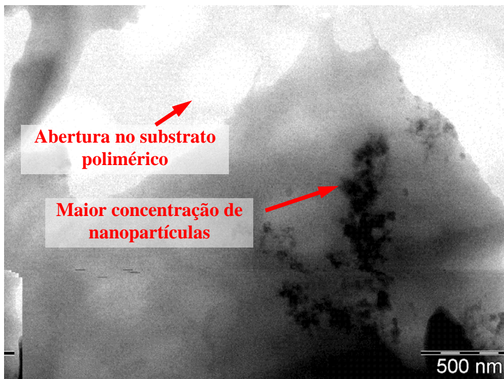
Figura 5.6 – Microscopia eletrônica de transmissão do nanocompósito epóxi/SiO 2 com fração de massa de 3% (magn. 40.000x).
