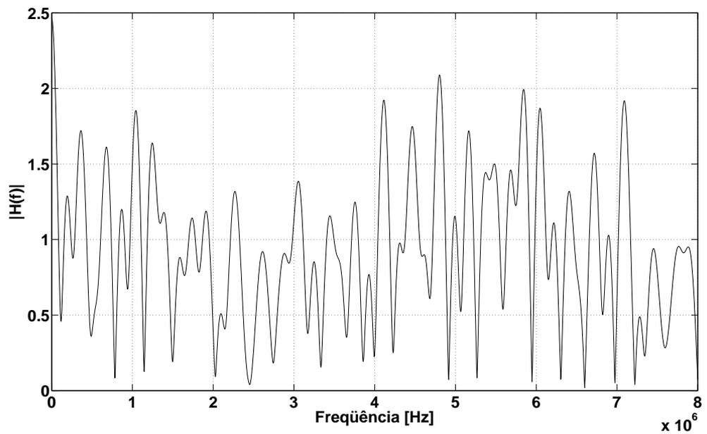
Figura 4.9: Resposta em frequência do canal Brasil C.
