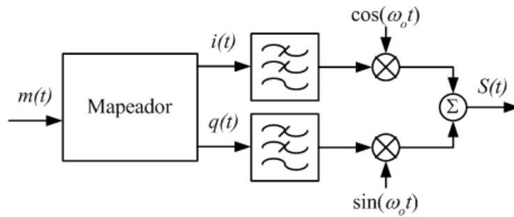
**Figura 4.1:** Modulador  $M$ -QAM.
