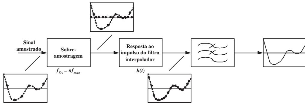
Figura 3.6: Diagrama em blocos da interpolação com filtro FIR.
