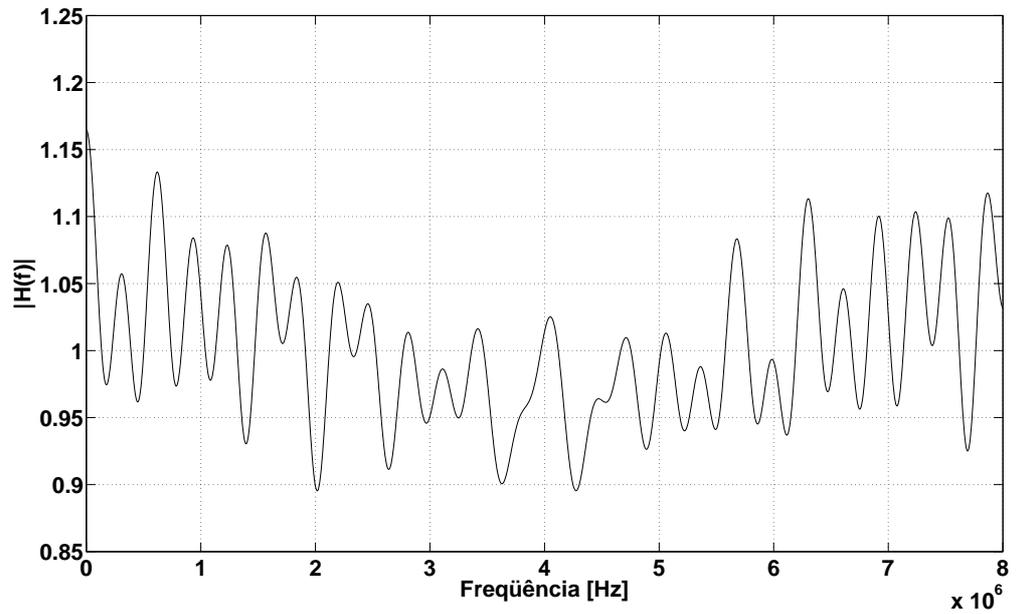
Figura 4.8: Resposta em frequência do canal Brasil A.
