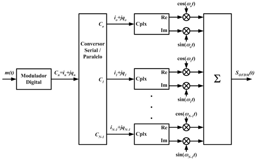
**Figura 2.1:** Diagrama em blocos do modulador OFDM.
