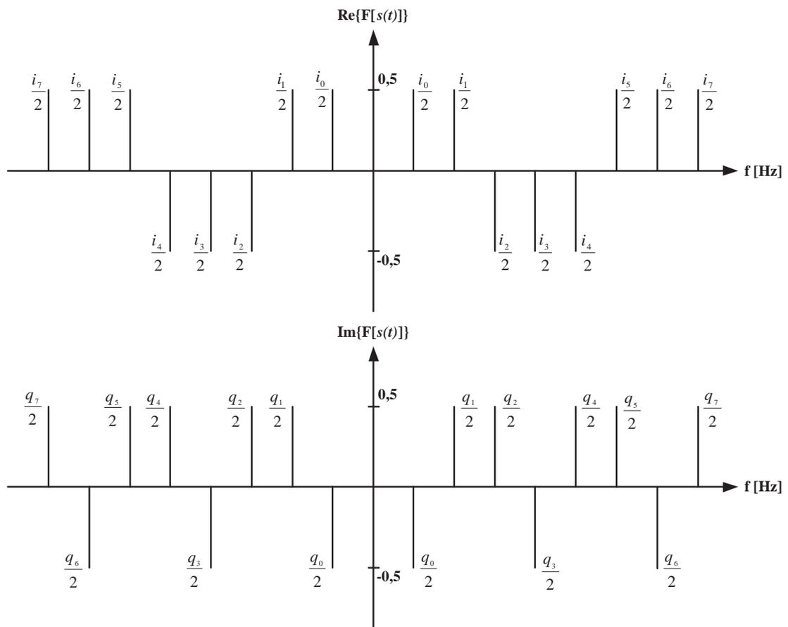
**Figura 2.3:** *Espectro de amplitude do símbolo OFDM.*
