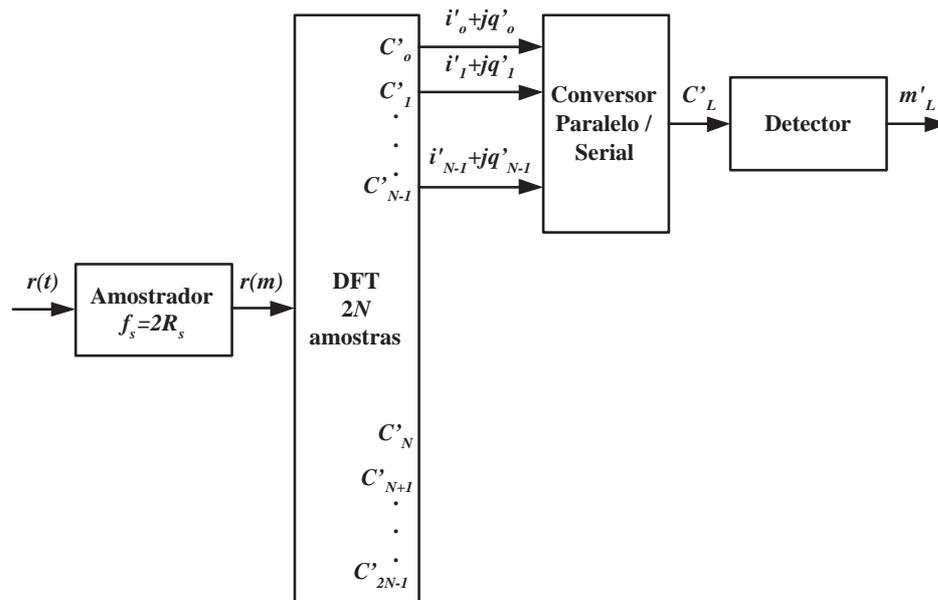
**Figura 2.6:** Demodulador OFDM utilizando a DFT.
