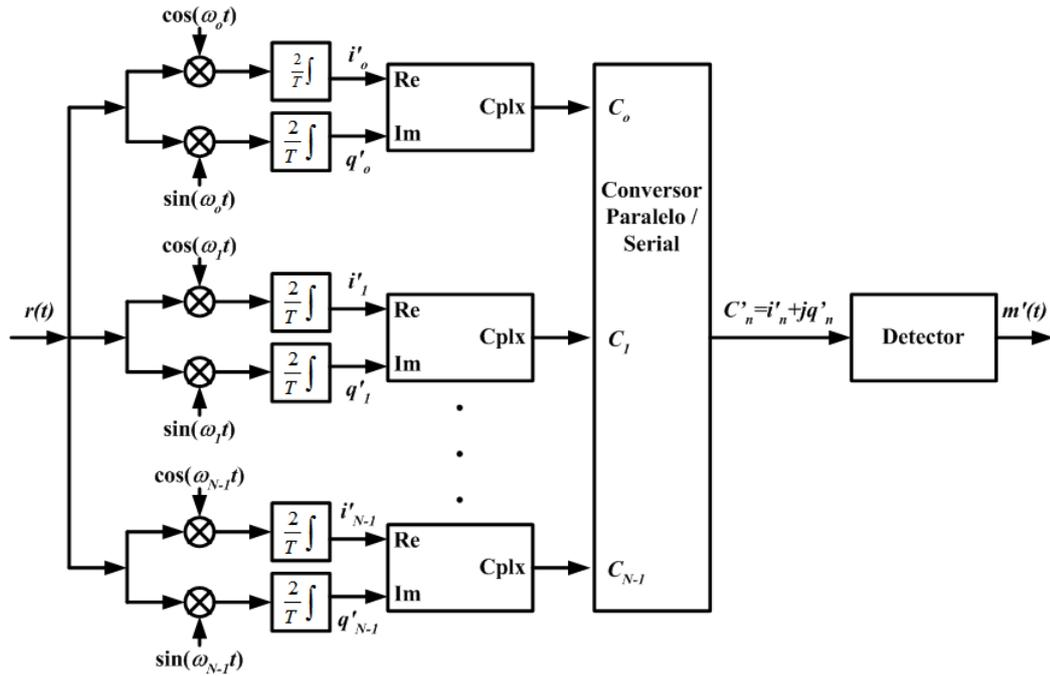
Figura 2.4: Diagrama em blocos de um receptor OFDM.
