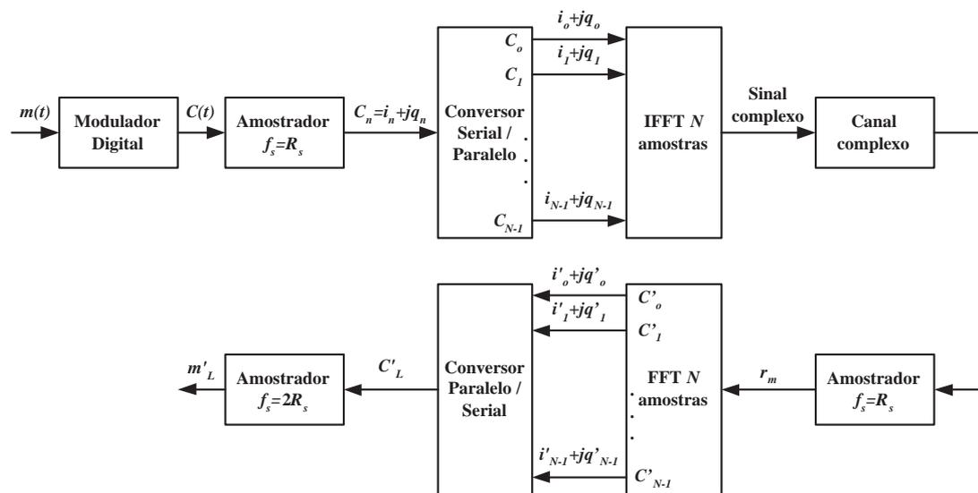
**Figura 2.7:** Sistema OFDM utilizando o método da IFFT/FFT.
