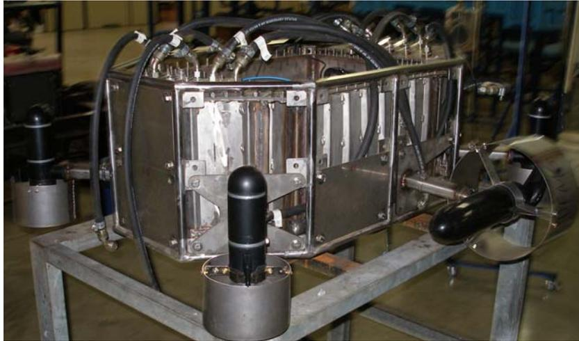
FIGURA 4.30 – Submersível VSI-02 em fase de montagem dos propulsores
