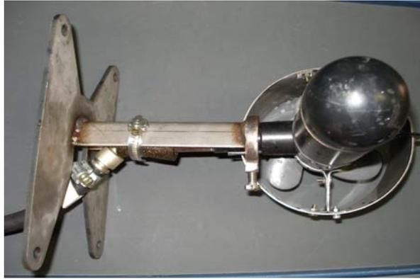
FIGURA 4.23 – Suporte dos propulsores verticais do VSI-02
