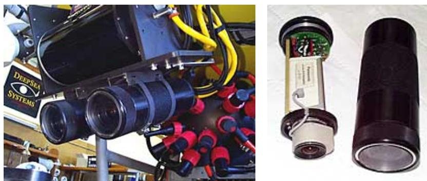
FIGURA 2.15 – Câmera utilizada no ROV MAX.
