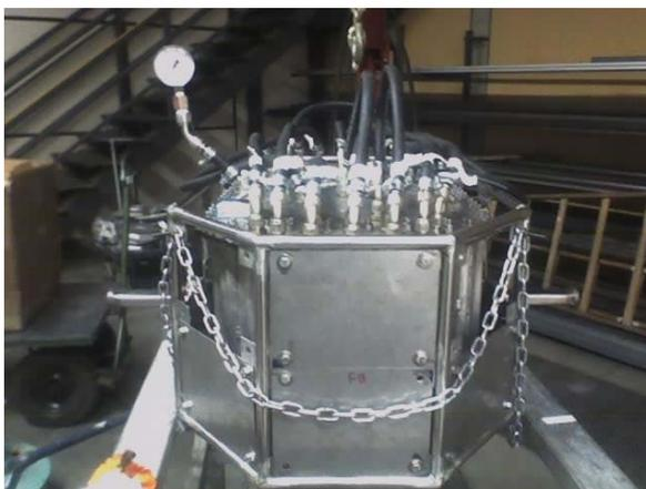
FIGURA 5.1 – Teste hidrostático realizado nos vasos de pressão do VSI-02
