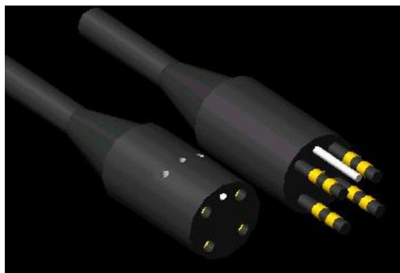
FIGURA 2.17 – Conexão para Cabo Umbilical (*tether*).
