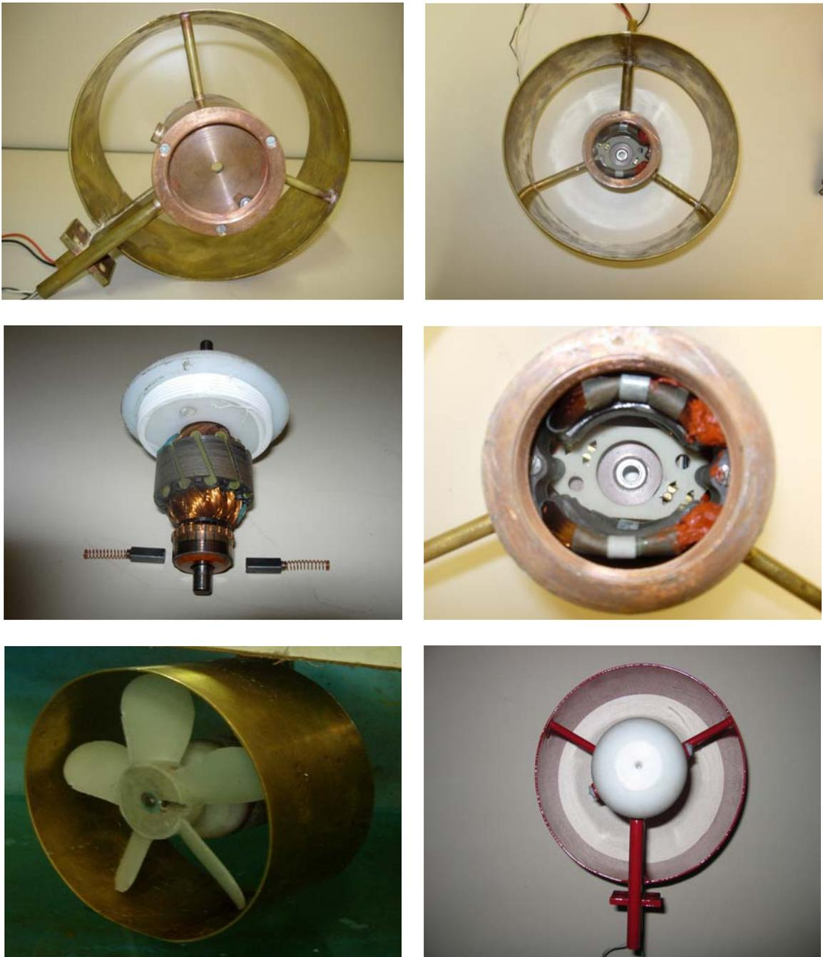
FIGURA 4.35 – Fotos dos componentes e do propulsor a Hélice durante a fase inicial de desenvolvimento.
