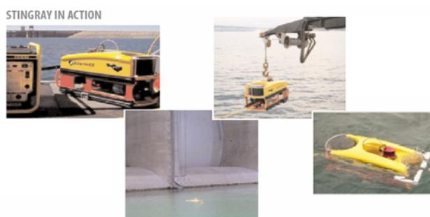
FIGURA 2.22 – Stingray em ação, sendo utilizado em inspeção de UHE's.
