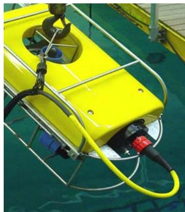
FIGURA 2.16 – Conexão do Cabo Umbilical ao veículo submersível.
