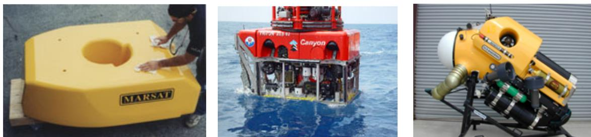
FIGURA 2.14 – Flutuadores utilizados em ROV.
