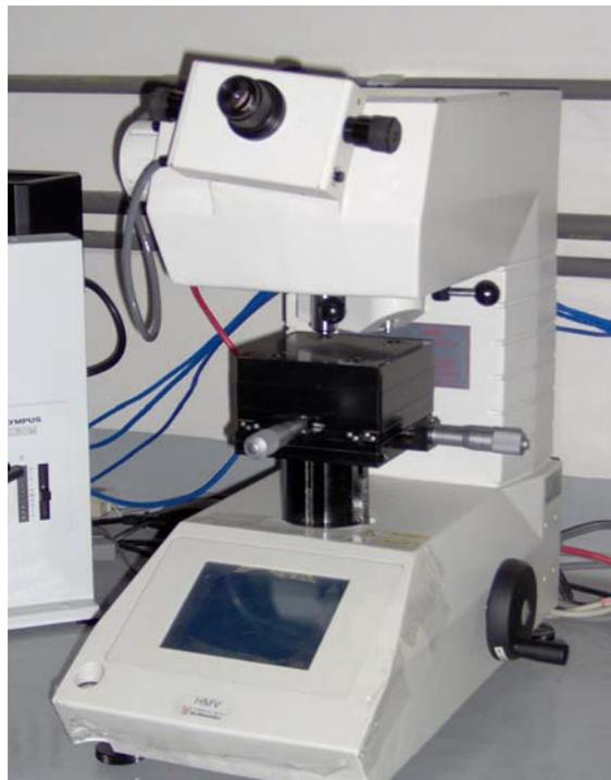
Figura 13. Microdurômetro utilizado no presente trabalho.
