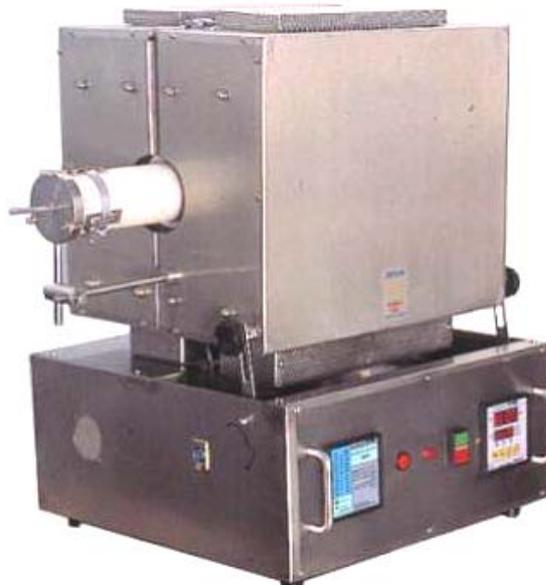
Figura 8. Forno tubular MAITEC FTE-1600/H utilizado para a sinterização dos corpos de prova.
