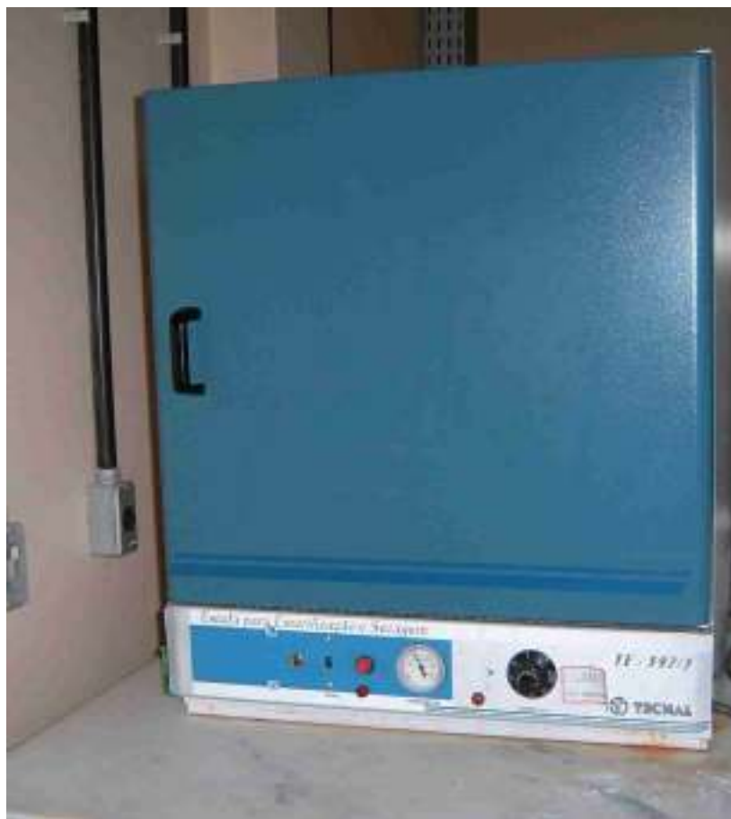
Figura 3.9: Estufa utilizada na secagem dos corpos de prova
