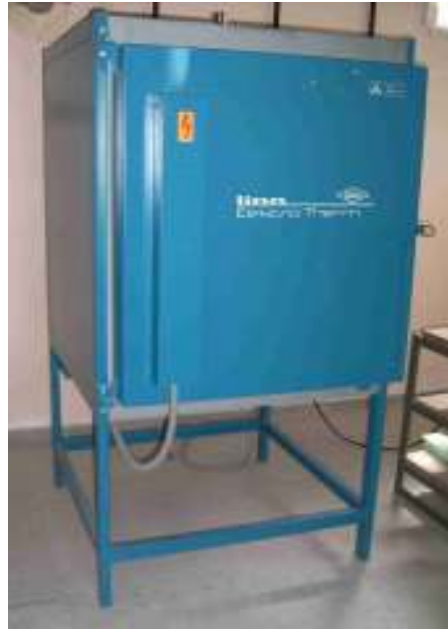
Figura 3.10: Forno utilizado para sinterização dos corpos de prova
