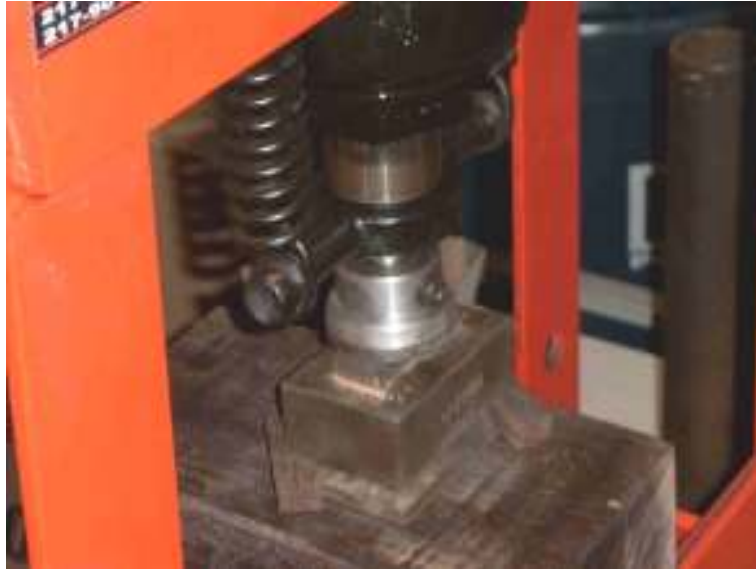
Figura 3.7: Prensagem dos corpos-de-prova
