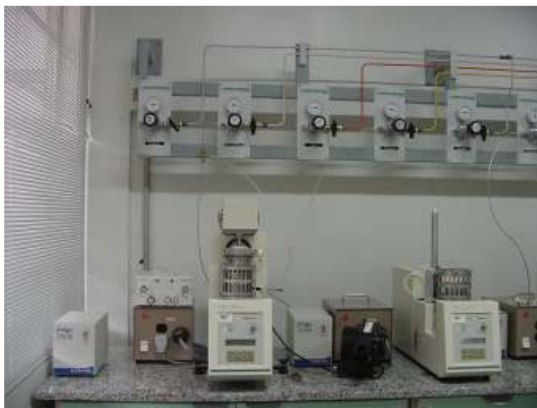
Figura 3.11: Analisadores termogravimétrico e termodiferencial
