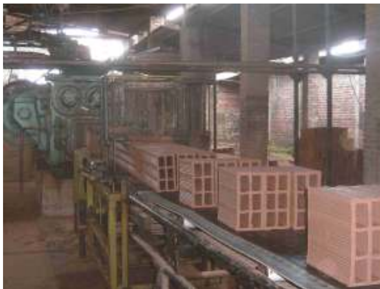
Figura 2.9: Vista do processo de extrusão (maromba)
