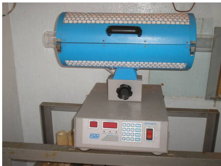
Figura 22 – Forno bipartido com controle programável de temperatura.
