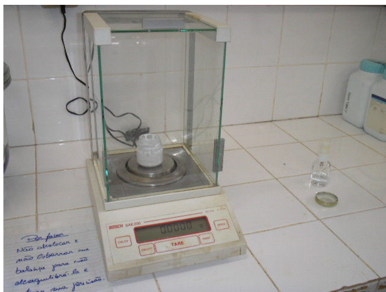
Figura 21 – Balança de precisão para pesagem de reagentes. Fonte: Fotografia do autor.
