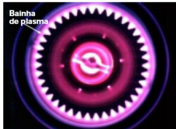
**Figura 1.1 - Formação da descarga brilhante na nitretação (PINEDO, 2004).**
