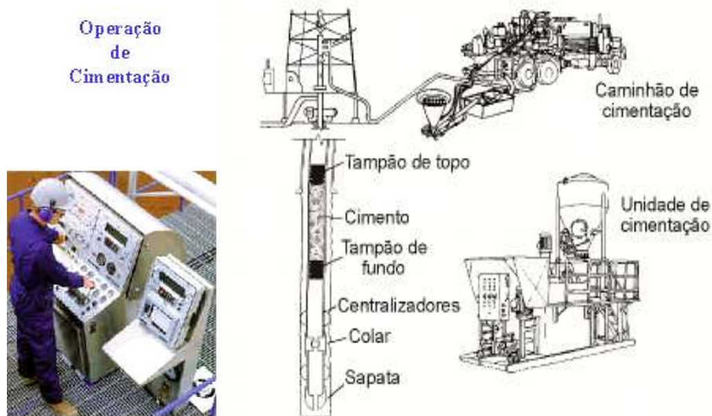
Figura 3.5 – Esquema de cimentação de poço de petróleo.
