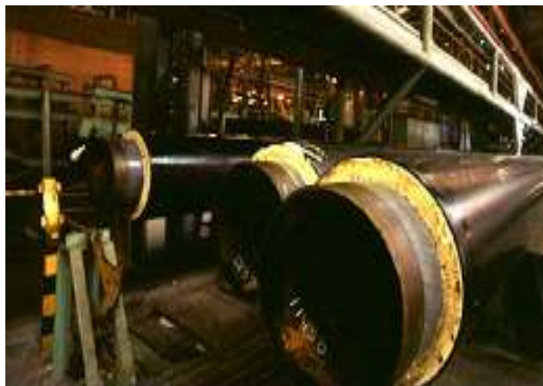
Figura 4.2 – Tubos OCTG para operações de perfuração, revestimento e produção [APLICAÇÕES DO NIÓBIO, 2005].
