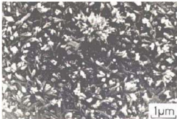
Figura 2.1 – Micrografia Eletrônica de Varredura do cimento Portland após 3 h de hidratação [MONTEIRO, 2002]
