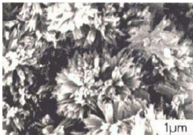
Figura 2.2 – Micrografia Eletrônica de Varredura do cimento Portland após 10 h de hidratação [MONTEIRO, 2002]
