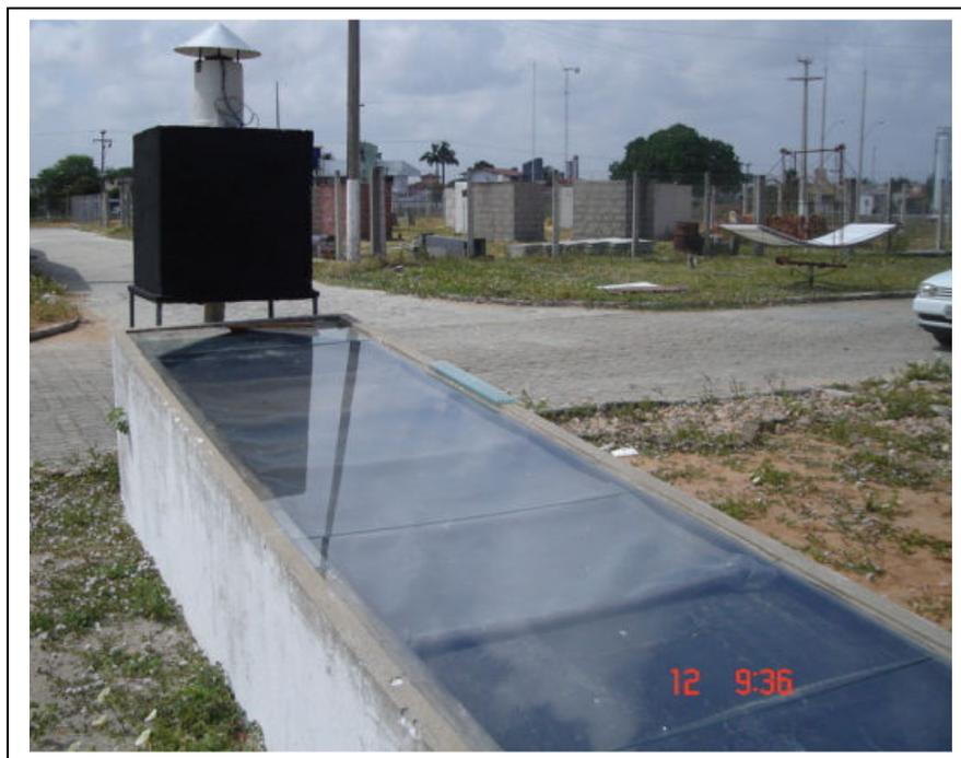
**Figura 2.13: Secagem solar de exposição indireta, UFRN/Natal**
