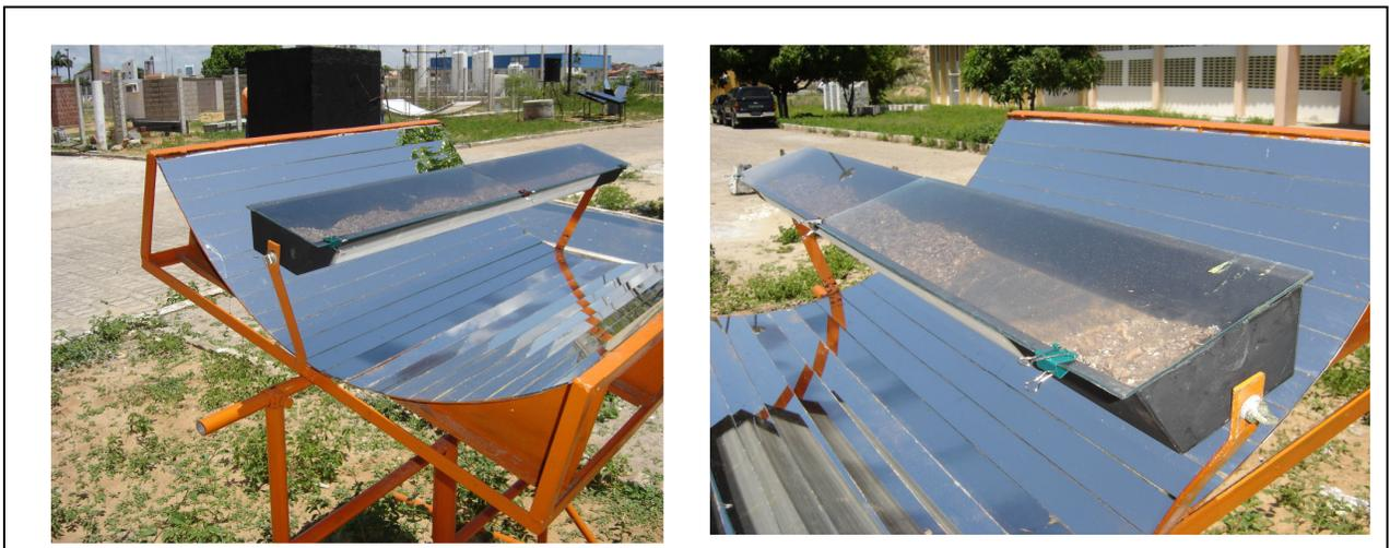
**Figura 4.4: Secador solar com concentrador**
