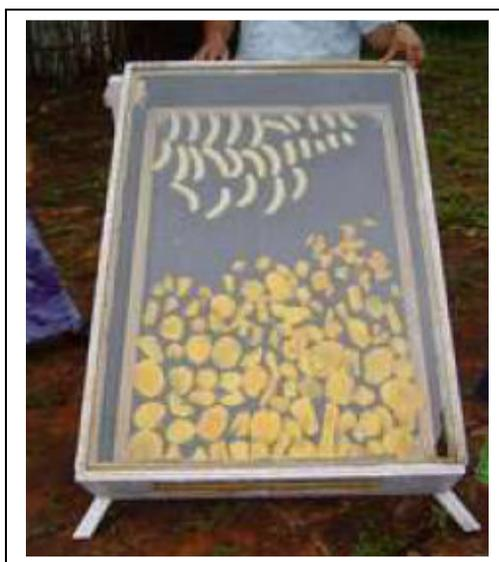
**Figura 2.10: Secador solar de exposição direta utilizado na secagem de frutas**
