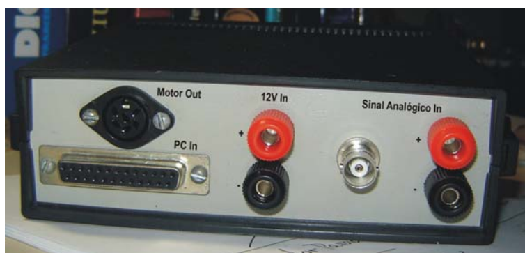
Figura 2.15. Vista traseira do dispositivo Conversor A/D e Driver de moto de passos.
