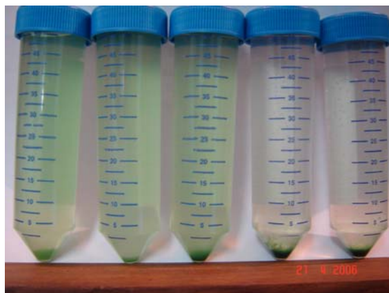
Figura 3.2. Amostras submetidas a diferentes pressões 48 horas após a aplicação. Da esquerda para a direita: tubo controle, 5 MCA, 15 MCA, 25 MCA e 35 MCA.
